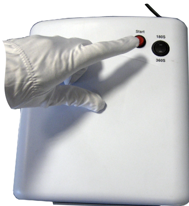
Рис.12 Включение экспонирующей камеры кнопкой «Start»
