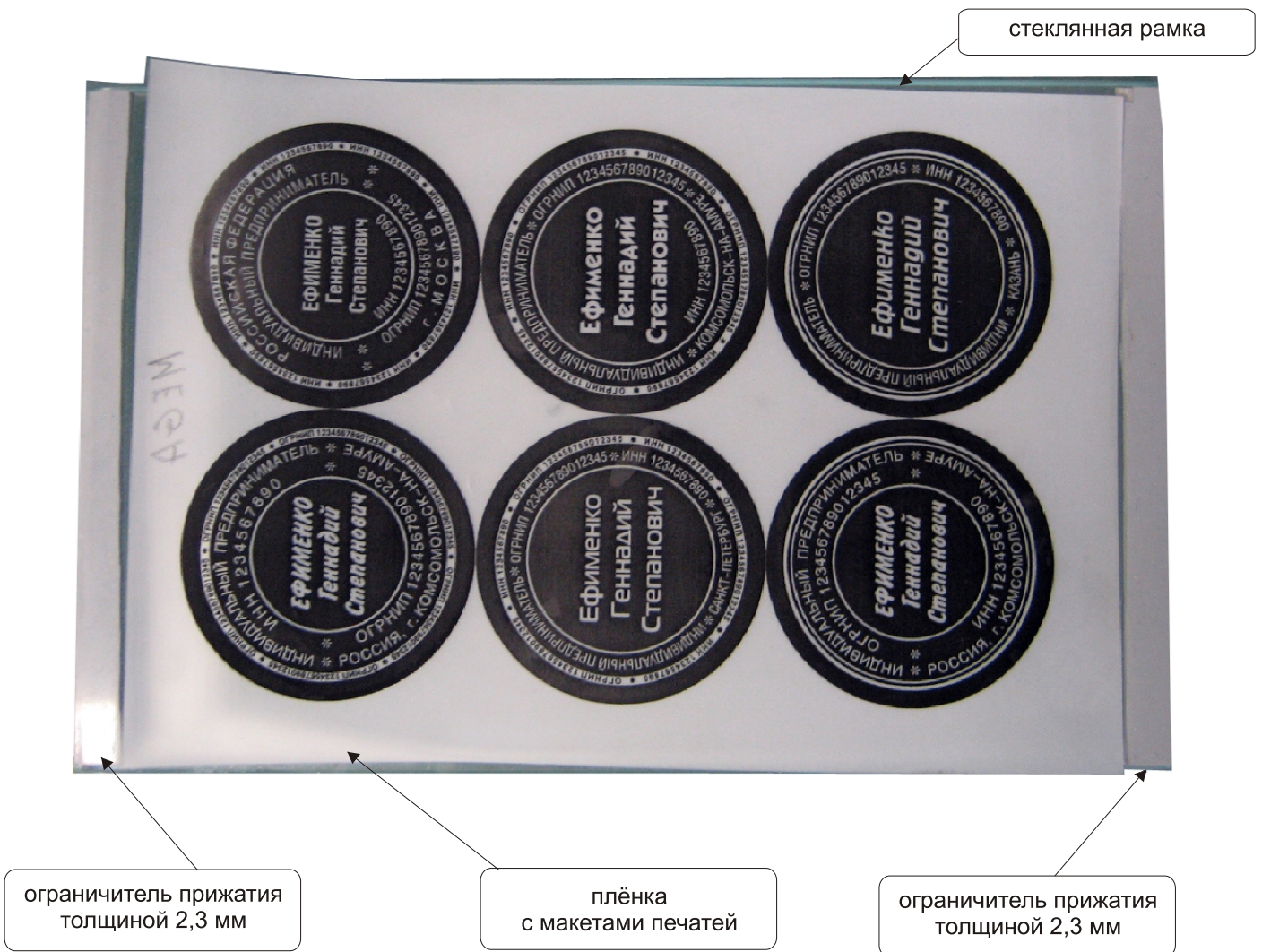
Рис.8 Расположение плёнки на стеклянной рамке с ограничителями прижатия
