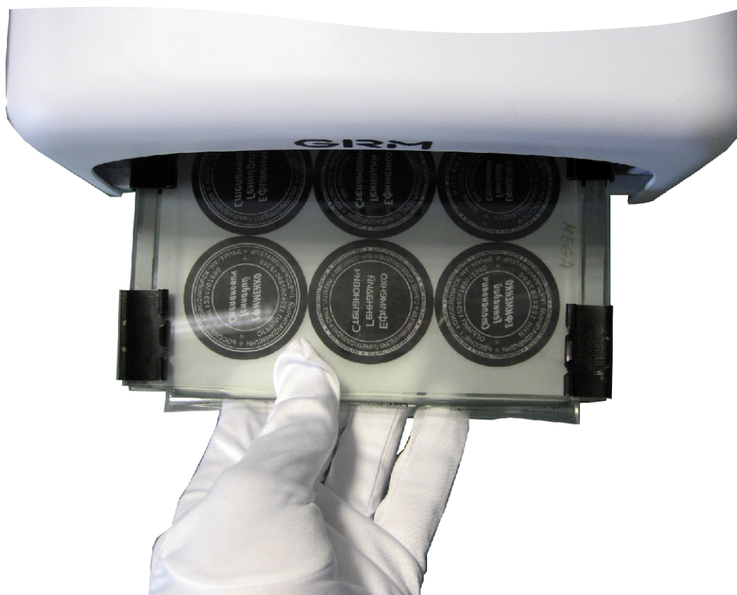
Рис.13 Засветка оборотной стороны кассеты(макеты в зеркальном отображении)
