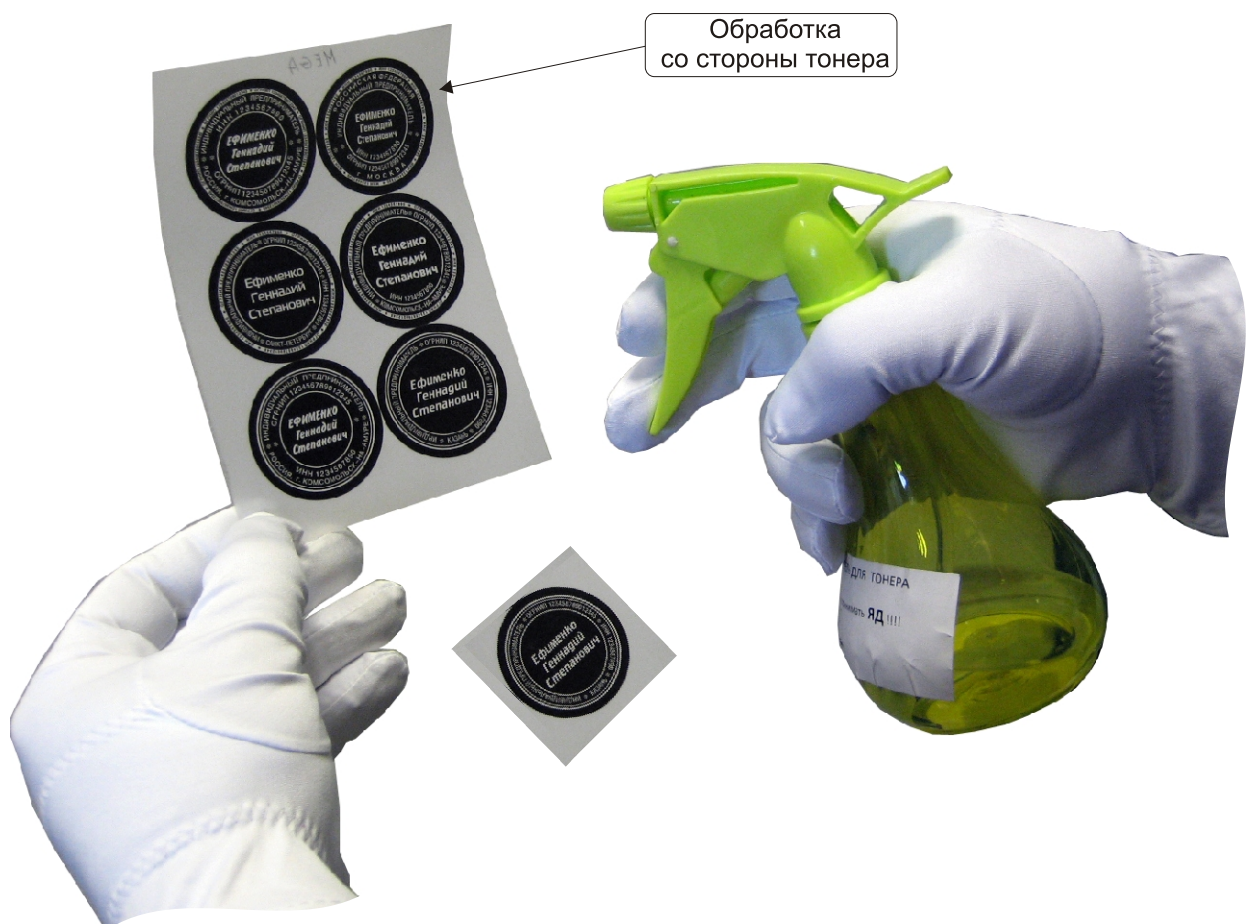
Рис.7 Обработка плёнки увеличителем плотности тонера
