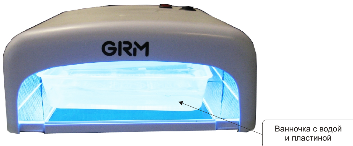
Рис.16 Засветка фотополимерной пластины в воде
