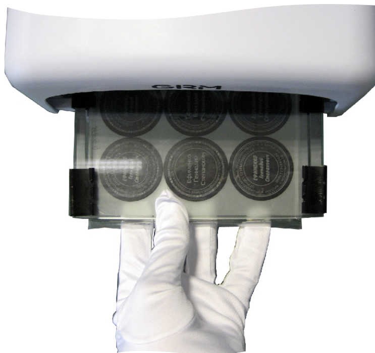
Рис.11 Помещаем кассету под лампы экспонирующей камеры
