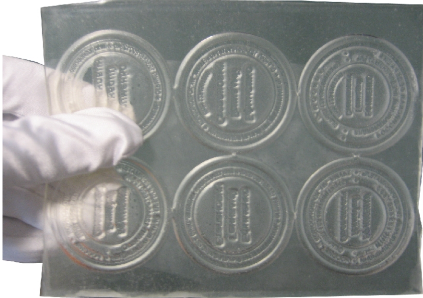
Рис.15 Промытая фотополимерная пластина с клише печатей
