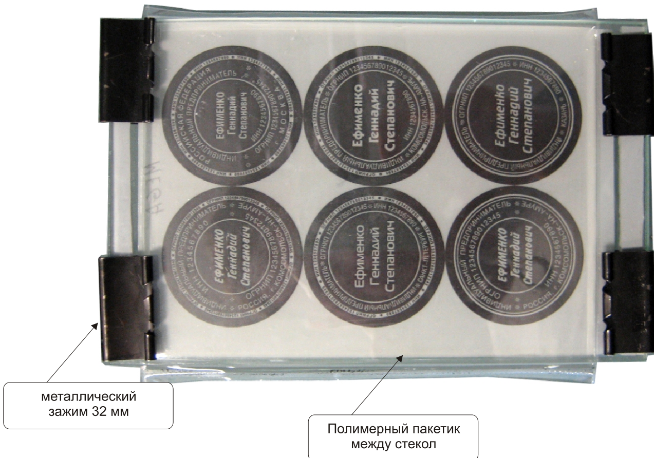
Рис.10 Кассета полностью подготовленная для засветки (ручки зажимов сняты)
