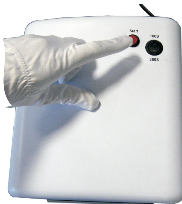
Рис.12 Включение экспонирующей камеры кнопкой «Start»
