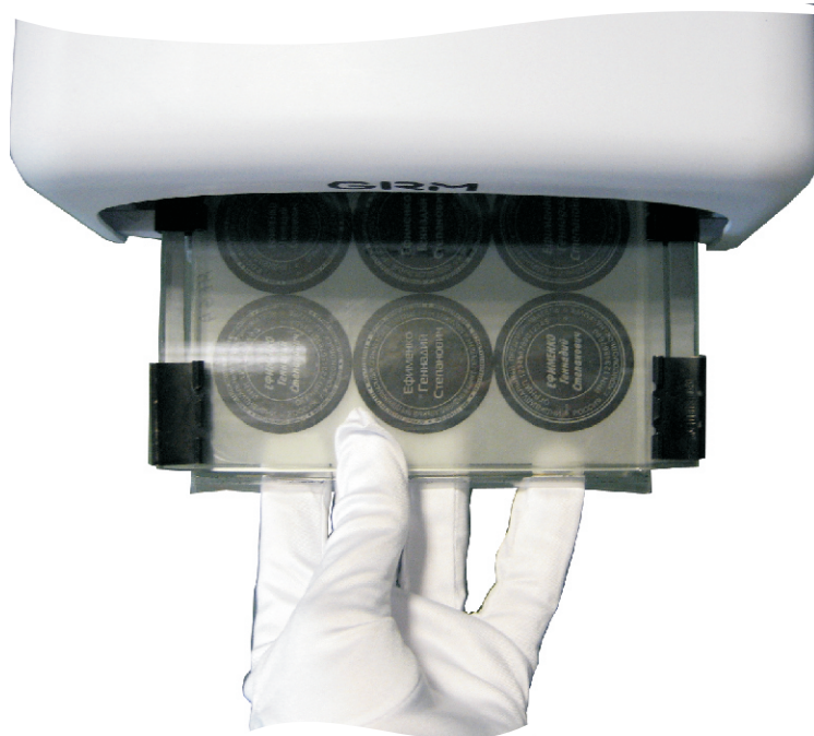
Рис.11 Помещаем рамку под лампы экспонирующей камеры
