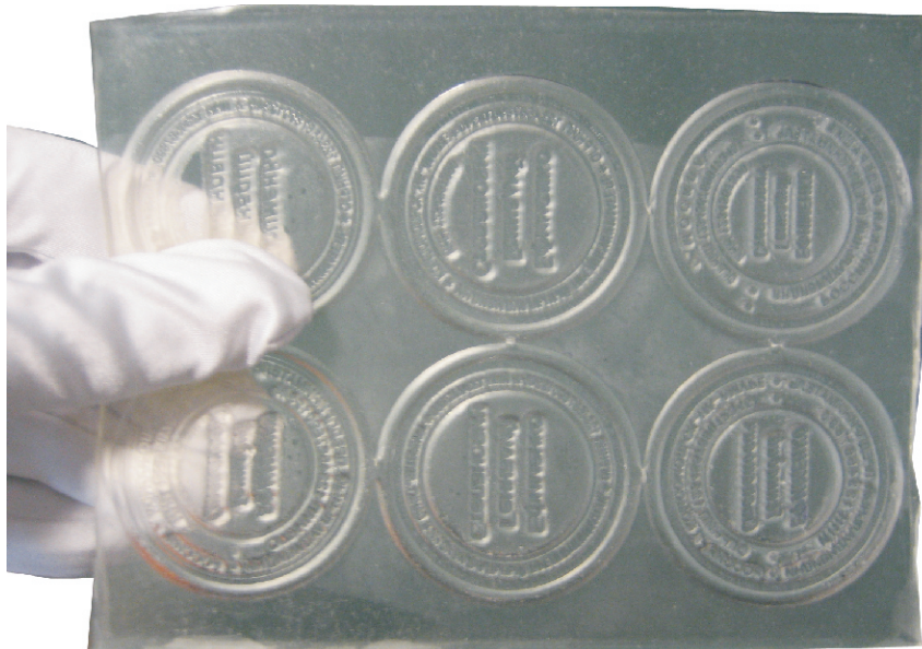
Рис.15 Промытая фотополимерная пластина с клише печатей
