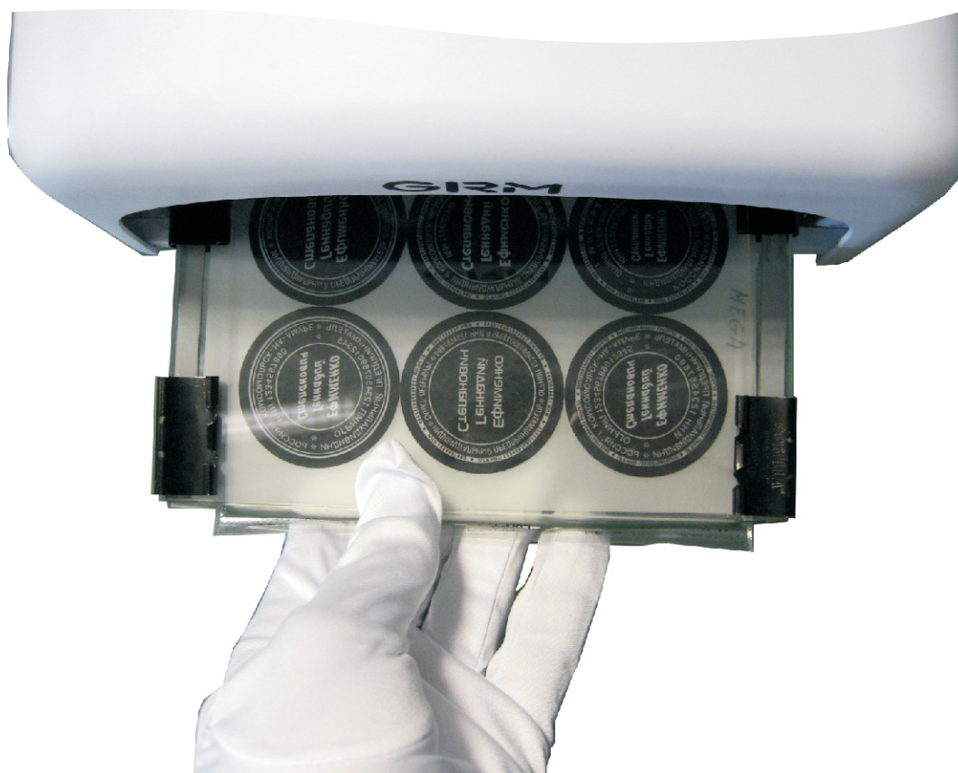
Рис.13 Засветка оборотной стороны кассеты(макеты в зеркальном отображении)
